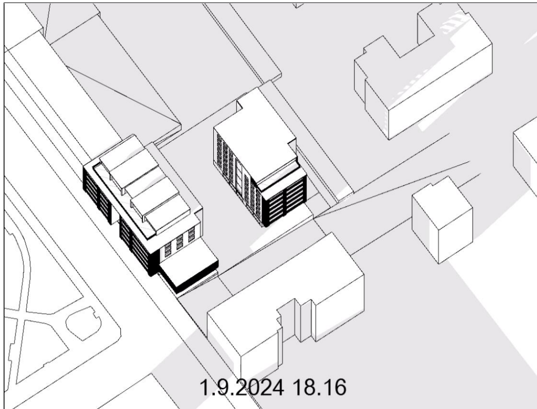
Kuva 16 Ote varjostustarkastelusta, tilanne 1. syyskuuta. Suunnittelualueen kaakkoispuolella osoitteessa Savilahdenkatu 1 on 7-kerroksinen asuinkerrostalo, jonka ikkunanäkymiä viitesuunnitelman mukainen B-talo muuttaa. Uusi rakennus sijoittuisi noin 30 metrin etäisyydelle nykyisestä rakennuksesta. Uusi rakennus sijoittuu olevan rakennuksen länsipuolelle, eli uusi rakennus varjostaa iltaisin matalalta paistavan auringon aikaan Savilahdenkatu 1:n julkisivua.
